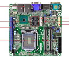
— Mini PCIe socket — M.2 socket — LVDS
